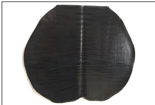
Рис. 7: Тест не пройден= не однородная смесь
