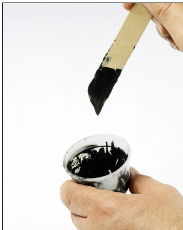
Рис. 9: Материал рвется, сразу после поднятия шпателя: время жизнеспособности смеси закончилось
