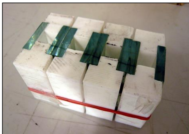
Рис. 17: Фиксация элементов с помощью резинового кольца и липкой ленты
